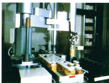
トレイの中の PET 容器のバ ーコード No を点検するロボ ット
