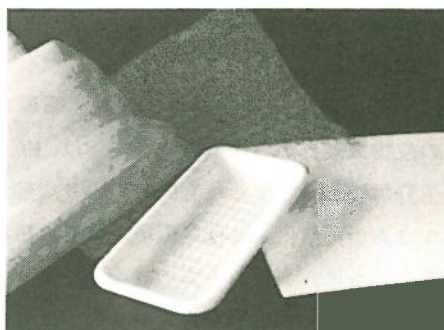
図2 生物崩壊性プラスチック 脂肪族ポリエステルにポリエチレン(LDPE)あるいはポリスチレン(この場合発泡体)を配合した試作品
