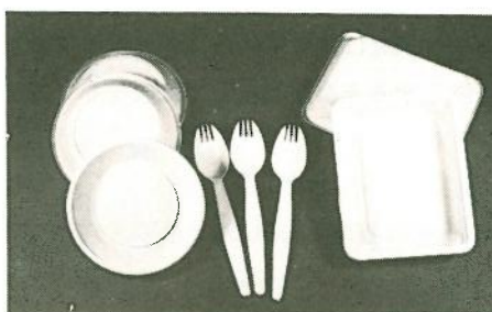
図3 生物崩壊性プラスチック 「環境調和型プラスチック」 脂肪族ポリエステルのポリカプロラクトンと炭酸カルシウム(50:50重量比)とのブレンド体
