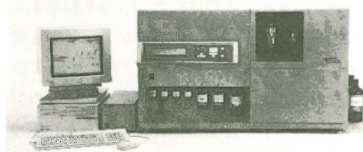
図2 バイオ・ラッド パーティクルデリバリーシステムPSD-1000/He
