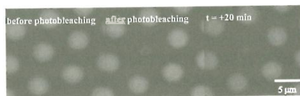
図2 SulforhodamineGによる蛍光消光回復実験(FRAP)
