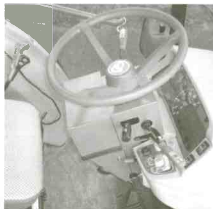
図5 後付け型自動操舵装置 (モータ駆動部)
