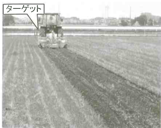
図1 直進誘導システムによる作業例 (大豆の播種)
