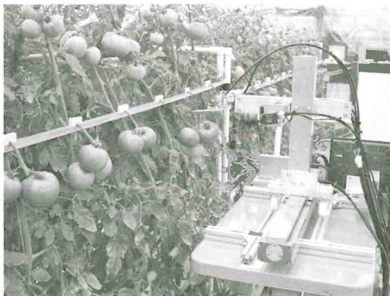
図8 トマト低段栽培における房採り自動収穫システムの動作試験 (野菜茶研 2008)
