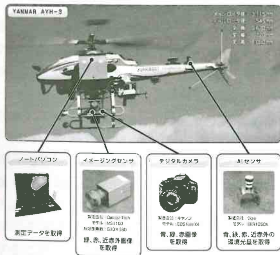
図-1 ヘリコプタリモートセンシングシステムの概要
