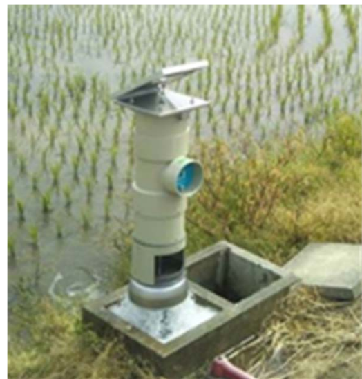
写真1：水田に設置されたセンサー付き制御装置 （農研機構農村工学研究部門提供）
