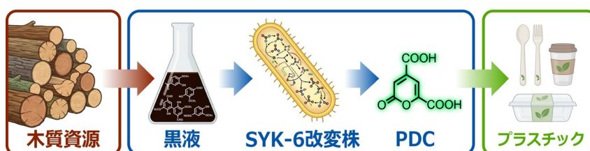
研究概要図：パルプ製造廃液（黒液）から SYK-6 改変株を用いたプラスチック原料・PDC への変換プロセス = 図、写真は長岡技術科学大学提供
