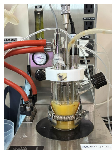
培養装置（ジャーファーマンター）を使い、SYK-6 改変株が効率よく PDC を生産できる条件を調べているところ
