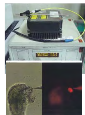
図3 LTM 装置 (上) 卵細胞への試料導入 (下)
