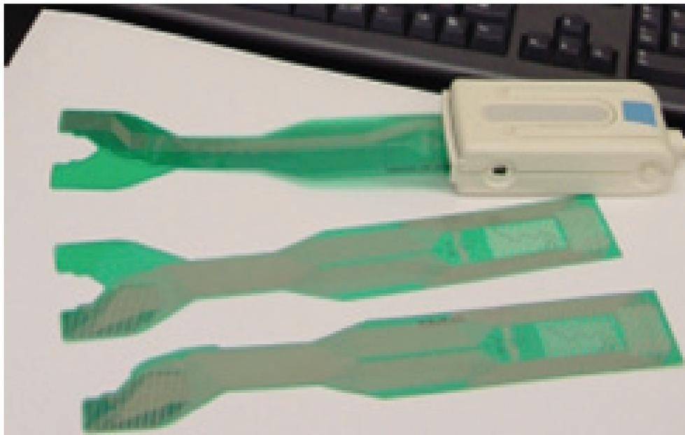
図 3-30 □ 高齢者向け食品の摂食圧を測定できるシートセンサ
