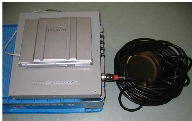
図 3-22 小型プロトタイプイルカ型対象判別ソナーシステムの全体図
