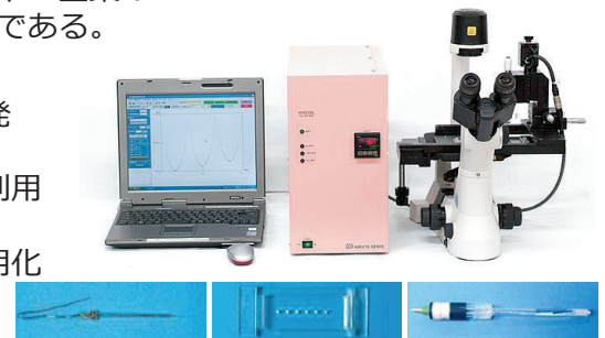
受精卵呼吸測定装置と周辺システムの例（クリノ株式会社HPより）
