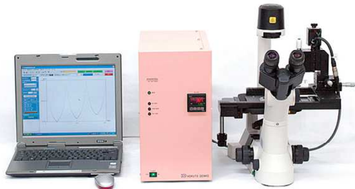
細胞呼吸活性測定装置 (CRAS-1.0) (ポテンシオスタット・倒立顕微鏡・呼吸測定ソフト内蔵PCにより構成される。)
