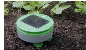
・ロボットソーラー除草機（フランクリンロボティクス）
