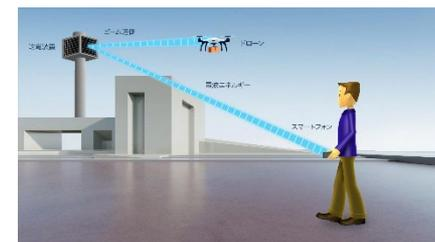
「空間伝送型ワイヤレス電力伝送システム」の電力供給イメージ（京セラHP） 45)
