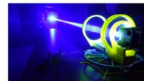
青色ダイオードレーザーモジュールを搭載。レーザーで雑草を刈ることが可能なロボット
