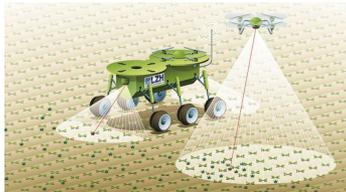
ドイツの研究機関レーザーセンターハノーバーでは、レーザー照射によって雑草の成長を抑制する新たな除草手法を開発。カメラを用いて農作物と雑草を判別し、雑草のみを標的にレーザーを照射する仕組み。自律走行ロボットや自動運転農機、ドローンなど、様々なプラットフォームに実装可能。
