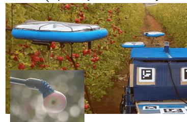
・2~4台の有線ドローンがカメラで色と大きさを評価し、熟した果物を吸引アームで収穫。
