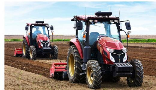
**図4 無人ロボットトラクター<sup>1)</sup>**
