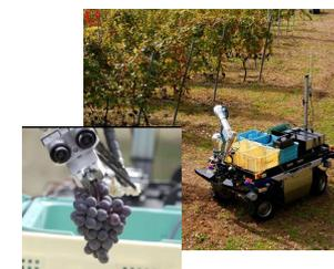
・垂直多関節ロボットと農業用UGVにより、ブドウを持って切断し自動で収穫。
