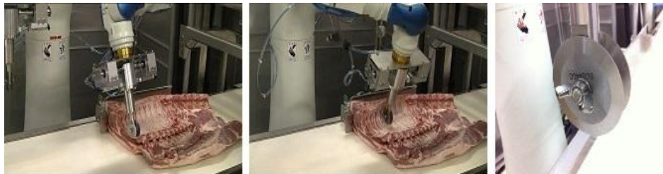
(写真2) 筋入れロボットの作動状況
