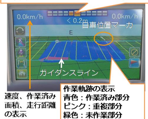
写真1 GPS ガイダンス装置のモニタ画面
