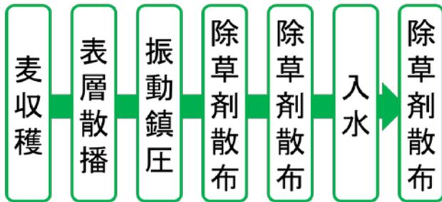
図1 表層散播と振動鎮圧による乾田直播栽培の作業工程
