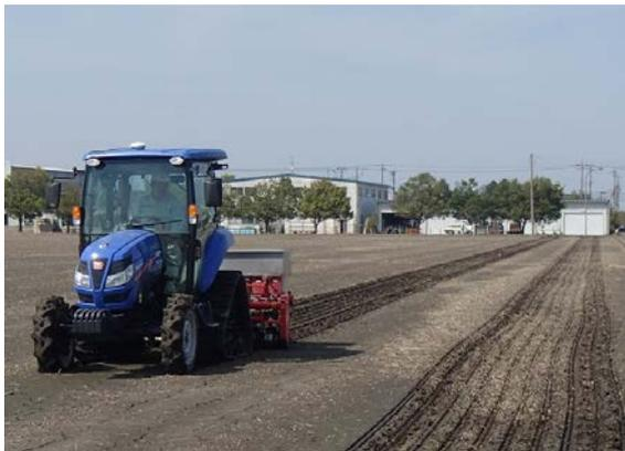
写真1 GPS自動操舵トラクタによる大画面圃場でのV溝直播
