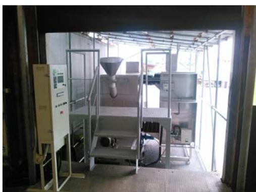
写真1 水産加工業者に設置した飼料化装置
