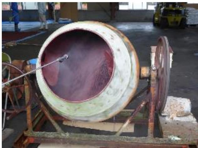
写真2 コンクリートミキサーでの被覆
