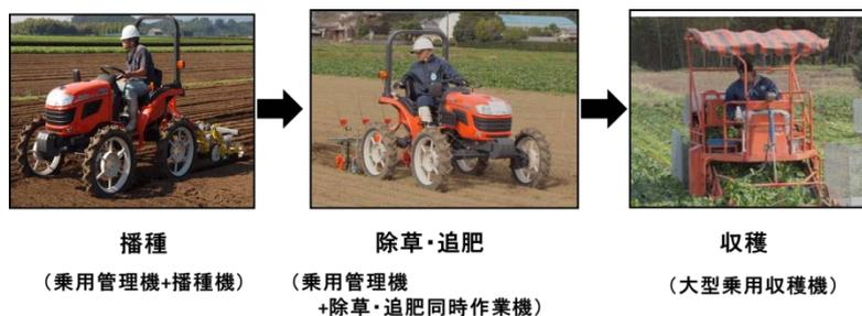
図 2 冷凍加工用ホウレンソウの乗用機械化一貫体系
