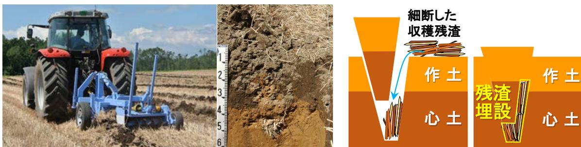
図 1 カットソイラの外観・施工断面・施工方法
