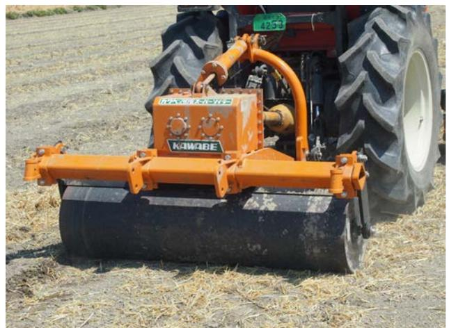
写真2 振動鎮圧による漏水防止
