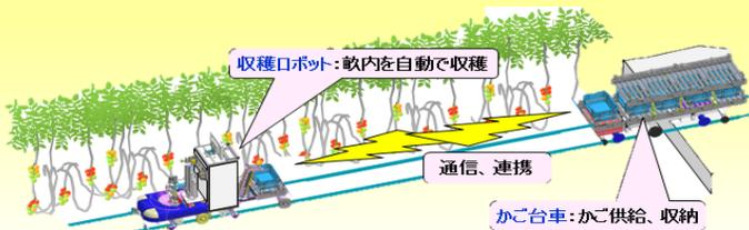
畝内の軌道上を自動走行しながら収穫適期のトマトを自動収穫し、かごに収納する。一杯になったかごは、かご台車に収納し、空のかごを収穫ロボットに供給する
