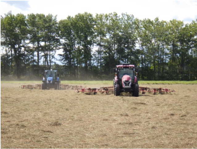
写真2 ロータリテッダを装着したロボットトラクタ（右）と有人トラクタの随伴協調作業
