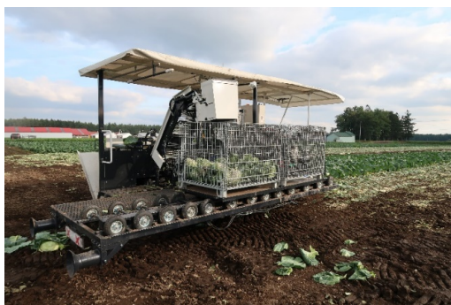
写真2 コンテナへ自動収納
