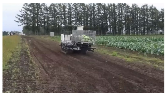
写真4 コンテナ自動運搬
