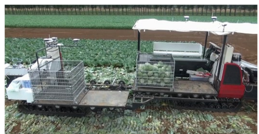
写真3 自動ドッキング・コンテナ交換
