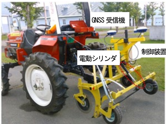
写真1 開発した根切り作業システムの構成
