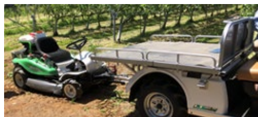
写真3 牽引型草刈機
