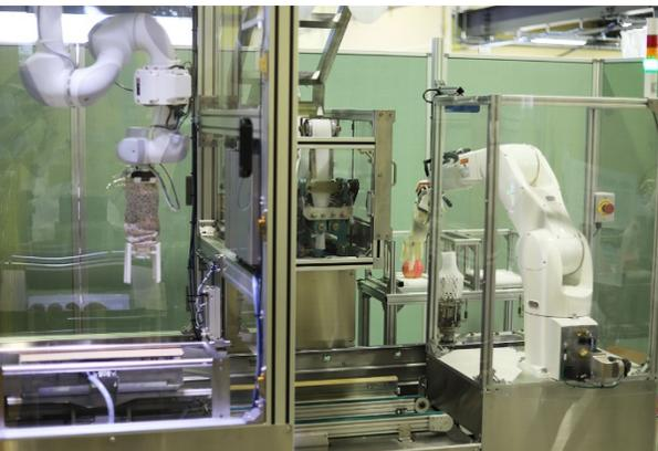
左から：自動箱詰め装置、キャップ自動装着装置、5指ハンドによる柔軟物（モモ）把持移載装置
