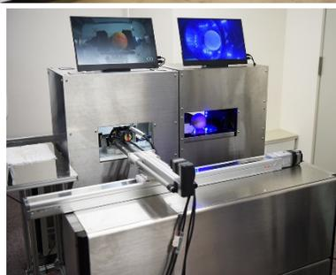
左：エアージェンによる卵除去 (左側) と可視光画像処理による食入孔検出 (右側) を並列処理可能な自動移載サブシステム (前後に独立したレーン有り)
