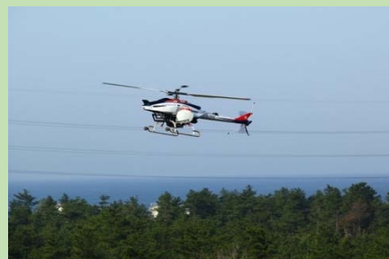
自動航行による被害予防のための薬剤散布 (高所作業車を使用しない)
