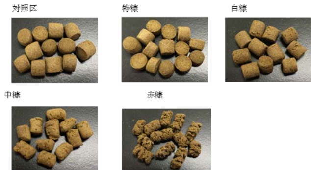
米の精米歩合90%の赤糠、85%の中糠、75%の白糠、中心部分の特糠を用いた造粒試験結果
