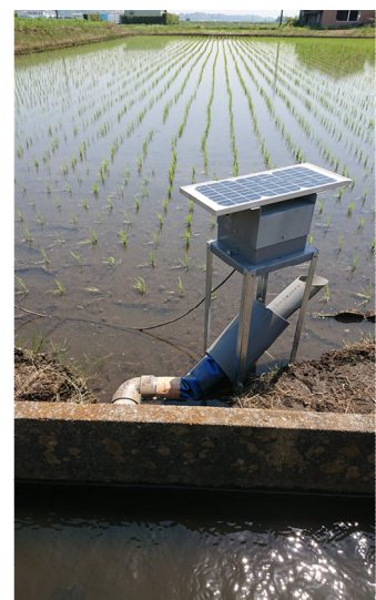
図3 最新の自動給水機（単体で作動する基本タイプ）
