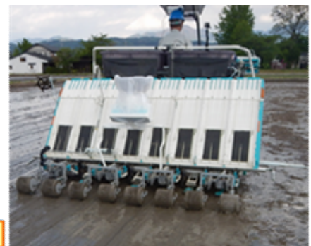
移植爪はケーブルタイで固定 肥料ホッパー→導管→吐出口→播種 かごローラで鎮圧
