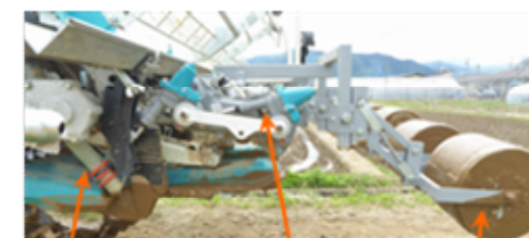
移植爪はケーブルタイで固定 肥料ホッパー→導管→吐出口→播種 かごローラで鎮圧
