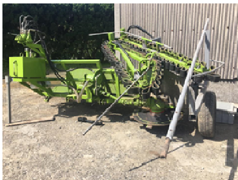
写真3 種苗用サトウキビ刈り倒し機（試作機）
