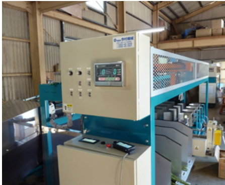
写真 1. 新規格に対応した切り花調整ロボット（試作機）：外観（左）・下葉処理部（右）
