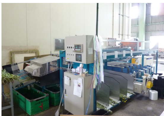
図1 切り花調整ロボット試作機の外観（左）と新たな出荷規格（切り花長 70cm・下葉処理 40cm）で調整された切り花（右）
