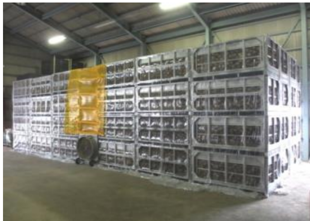
写真1 現地で簡易型差圧通風法により96基のコンテナを乾燥しているところ
