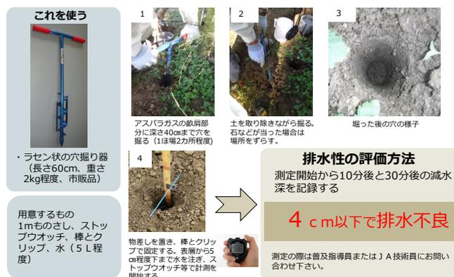
図3 簡易下層透水性診断手法
