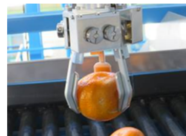
図4 ロボット搭載型プレ選果システムのRHハンドによる腐敗果の除去
