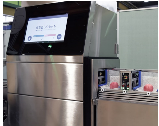
図3 X線を利用したモモシクイガ被害果検査装置
