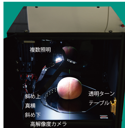
図2 食入孔検出サブシステム
