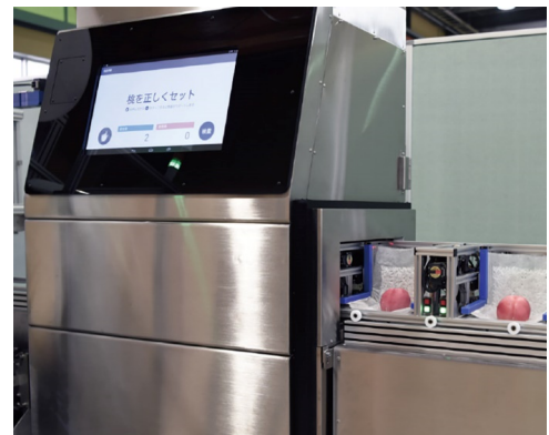
図 1 X 線を利用したモモシンクイガ被害果検査装置 (1 パレット 2 個モモタイプ)
