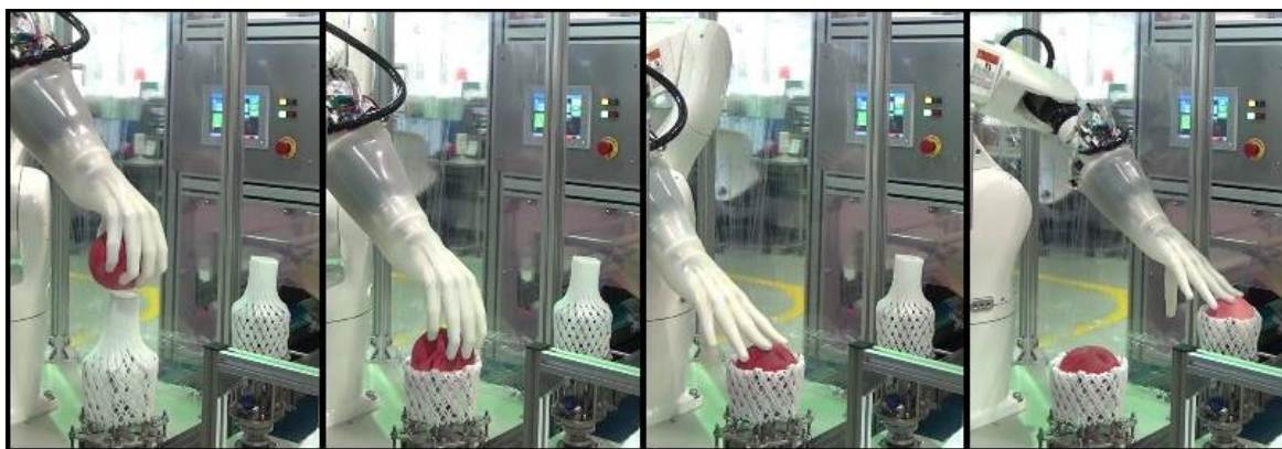
図1 柔軟物把持ロボットによるフルーツキャップ装着
