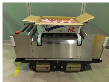
図3 モモ箱自動搬送台車の外観図
