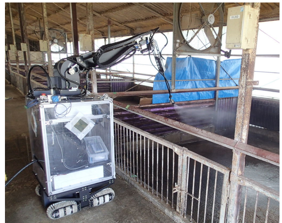
写真1 高機能型肥育豚舎用洗淨ロボット
