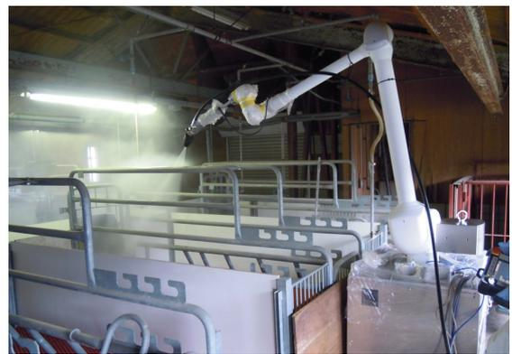
写真1 分娩豚舎用洗浄ロボット
