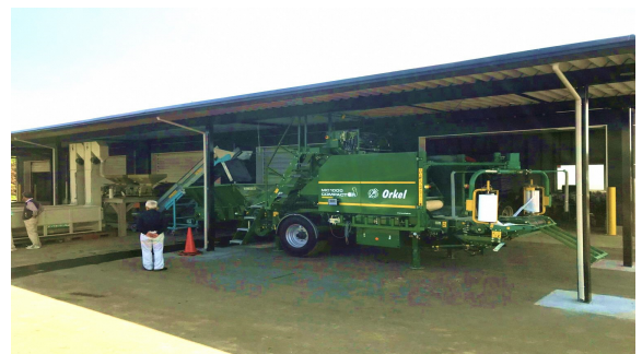
写真1 粃米サイレージ製造体系
