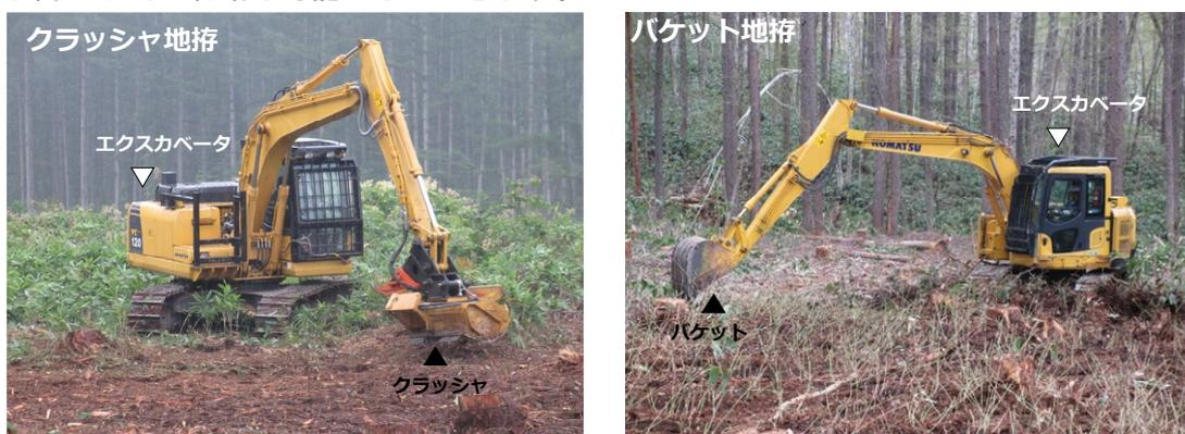
写真2 エクスカベータをベースとした効率的な地拵の機械化
