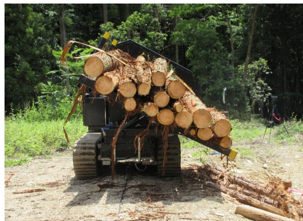
写真1 無人荷おろし作業中のフォワーダ
