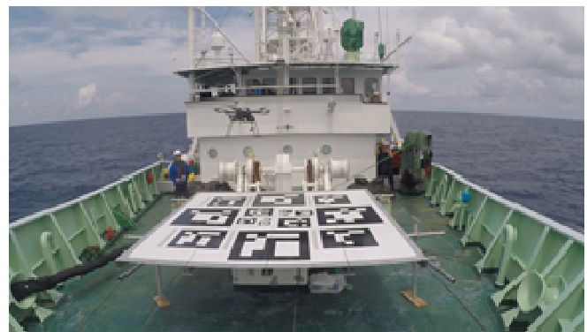
図 2 海外まき網漁船での実証の様子 （ドローンと甲板上に設置された離発着台）
