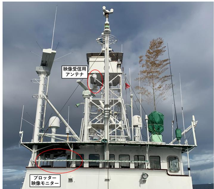
図4 映像受信用アンテナ設置状況
