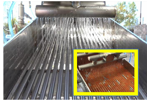
写真1 洗卵装置の稼働状況（衝撃に弱い卵を優しく、且つ確実に洗浄）
