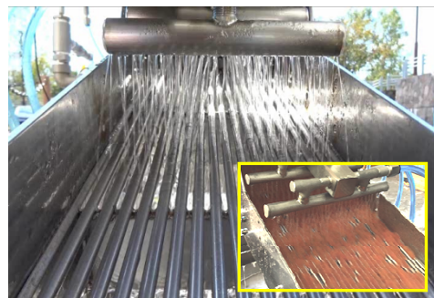
写真1 洗浄液供給部：多孔式シャワーヘッドにより卵への衝撃力を低減
