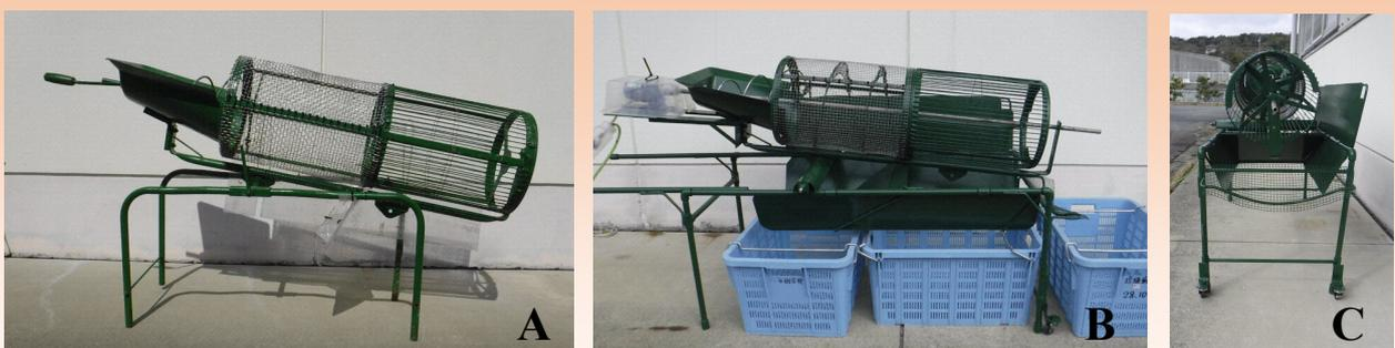
写真2 二段ドラム式選別機（A:手動式、B、C:電動式）
