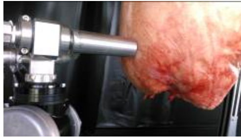
写真5 残毛除去ロボット（左）と 枝肉に付着した残毛除去の様子（上）
