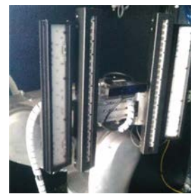
写真4 ロボットに取り付けた3Dカメラ
