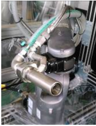
写真5 残毛除去ロボット（左）と 枝肉に付着した残毛除去の様子（上）
