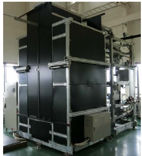
写真1 豚枝肉残毛自動脱毛機（試作機） （左前方が画像処理部、右後方が残毛除去部）
