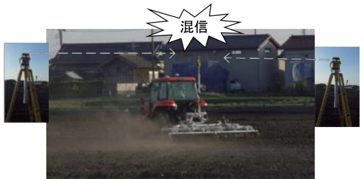
写真2 異なる発光器からのレーザー光が混信して能率的・計画的な作業を阻害する状況
