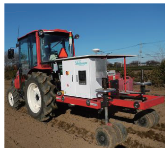
写真 1. トラクタ搭載型土壌分析システム (SAS)
