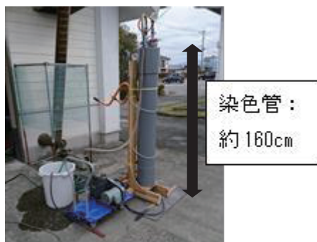
写真1 簡易減圧染色装置
